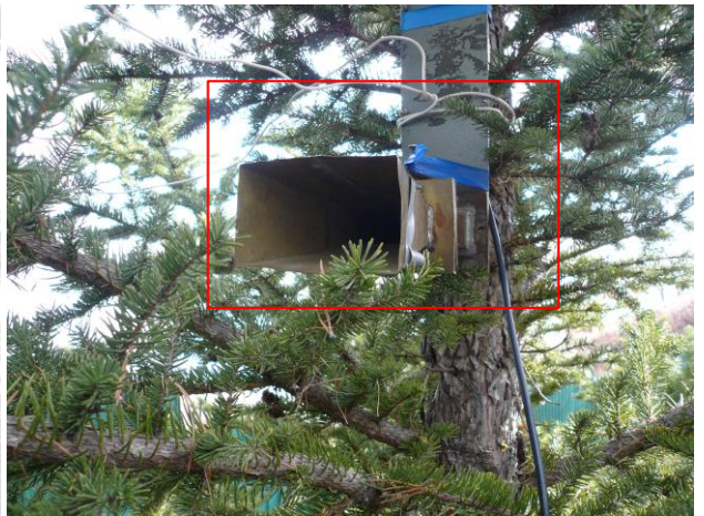
Рис. 4. СВЧ-генератор, установленный на дереве.
