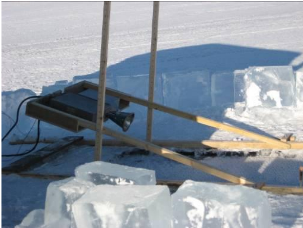
Рис. 6. Измерения радиотеплового излучения льда на проруби.
